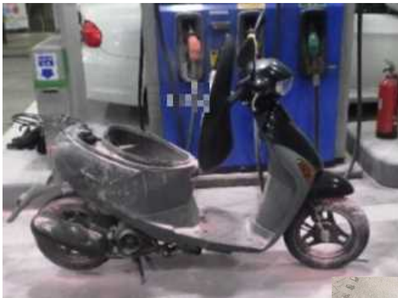
焼損した原動機付自転車
