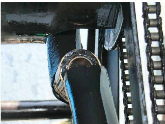
脱落により破断したホース
