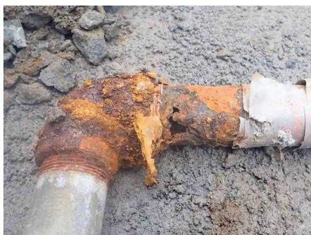
継手部分が特に腐食が進行している
