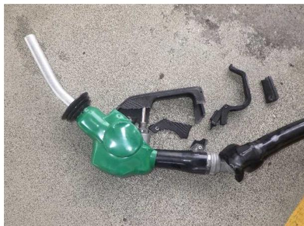
破損した給油ノズルの様子
