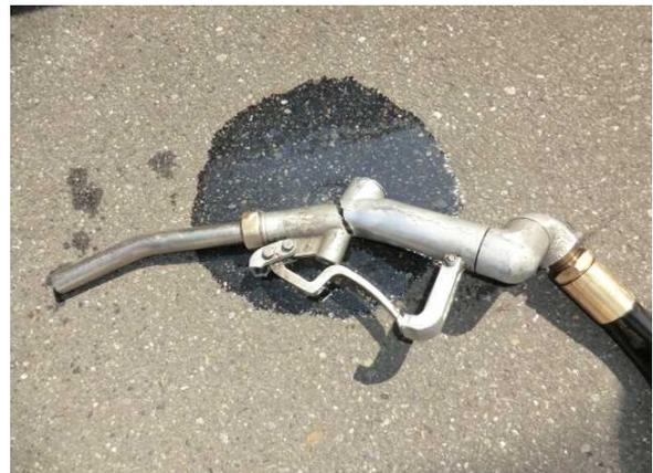
破損した給油ノズル
