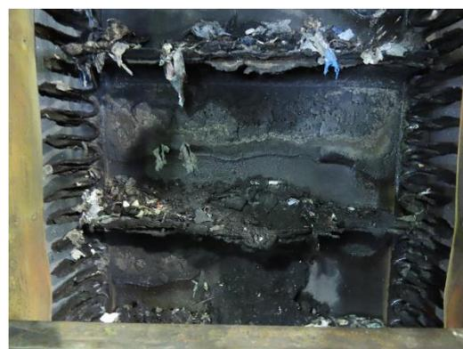
焼損したベルトコンベヤ内部
