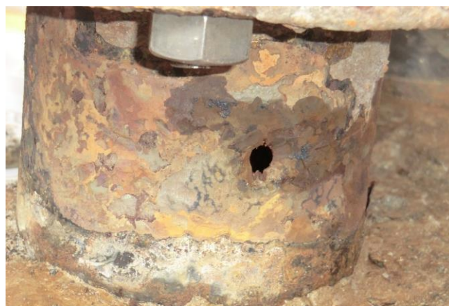
配管取付け部分の開孔状況
