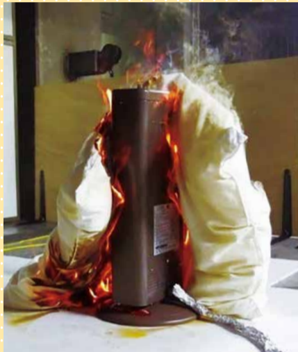
電気ストーブに布団が接触し出火した実験の様子
