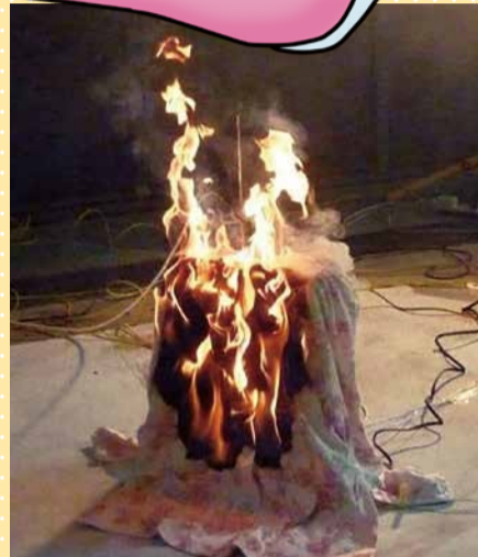
電気ストーブにパジャマが接触し出火した実験の様子
