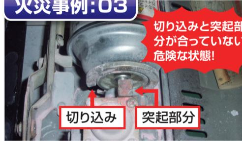
簡易型ガスこんろに燃料ポンベを正しく装着しなかったため、漏れたガスに引火し出火した。
