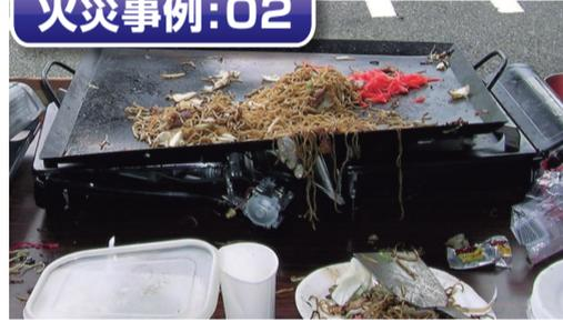
簡易型ガスこんろを2台並べて、鉄板を置いて使用したため、燃料ポンベが過熱されて破裂し出火した。
