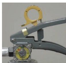
× 安全栓の抜けかけ
