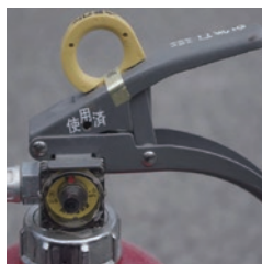
× 表示装置の脱落
