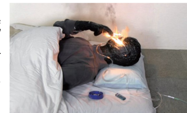
たばこの火源が鼻カニューレに着火 する検証実験の状況
