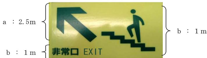
図11 階段に設置する避難方向明示物の例
