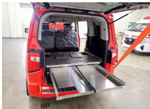
現場指揮板等収納場所
