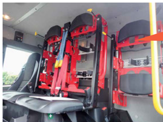
背当て部分に空気呼吸器を積載可能な構造
