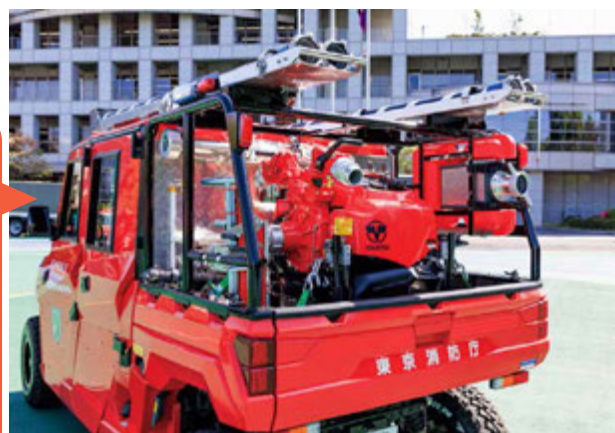
動力消防ポンプ積載状況
