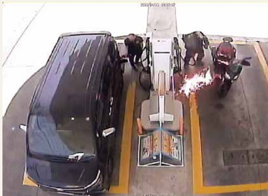
▲ 給油作業中に給油口付近から炎が出ている様子
