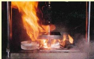
リチウムイオン電池がつぶされることで、発火することを再現した実験の様子
