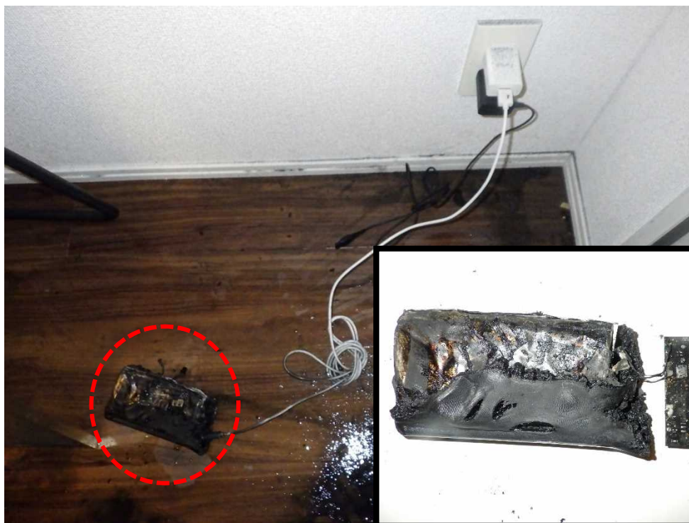
⑩充電中のモバイルバッテリーが 電池内部で短絡して出火した火災（11月）
