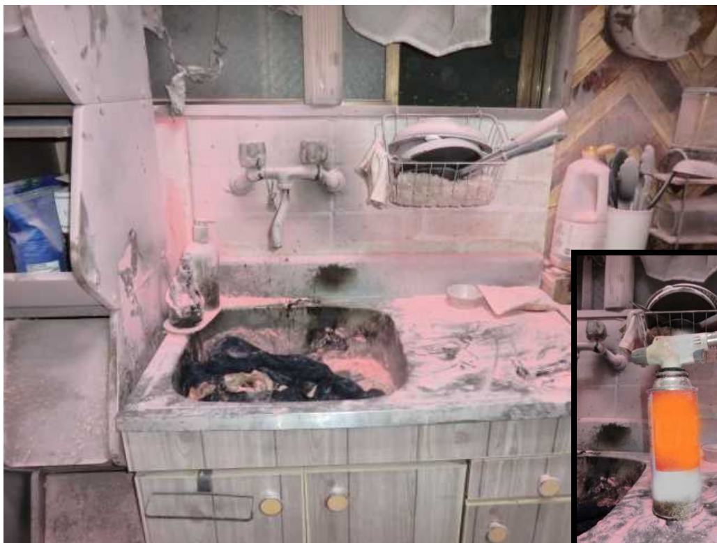
②ボタンガストーチバーナのボンベ接続部から 漏洩した可燃性ガスに引火した火災（4月）
