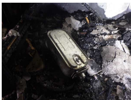
写真 8-4 カートリッジタンクの状況
