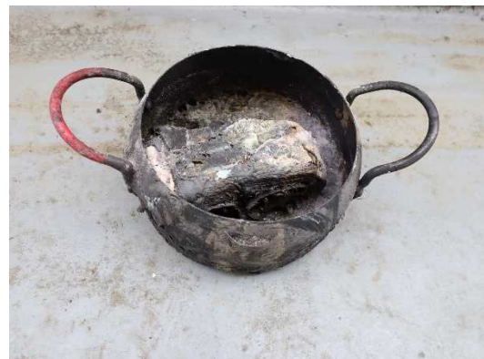
写真 9-4 鍋の焼損状況
