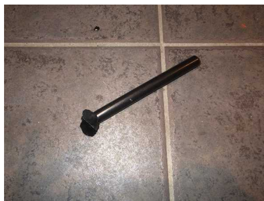
写真 8-2 樹脂製ブラシの焼損状況
