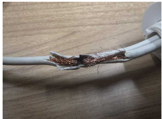
写真 21-4 焼損した電源コードの状況
