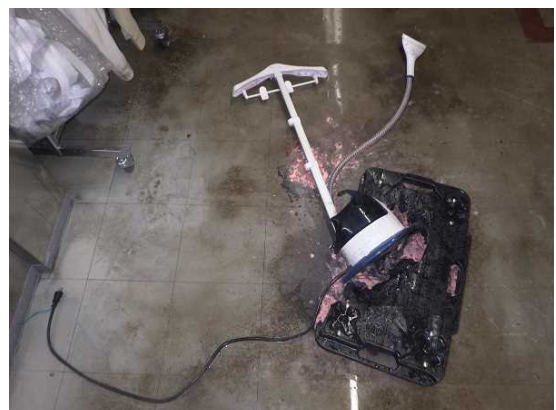
写真 30-4 焼損したスチームアイロン状況
