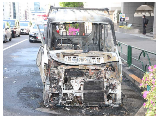
写真 29-2 焼損した車両の状況
