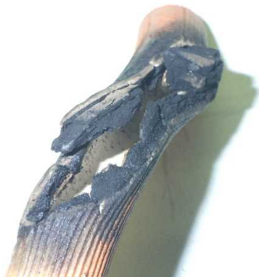
写真 23-1 ゴムホースの焼損状況
