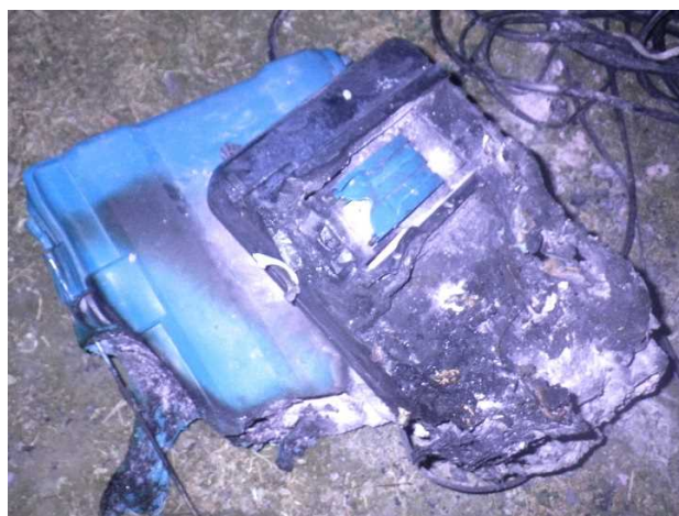
写真 25-2 焼損した電動工具の状況
