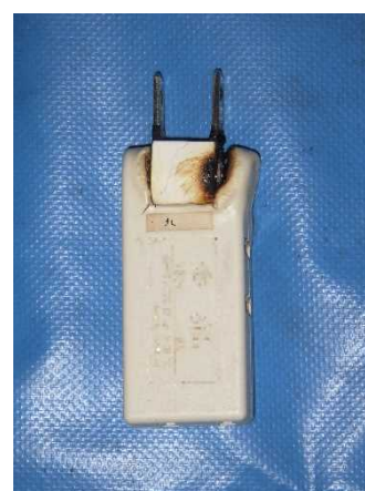
写真 18-10 焼損したマルチタップの状況
