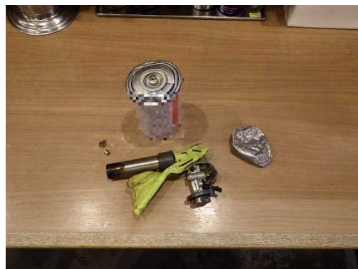
写真 11-6 ガストーチバーナの焼損状況
