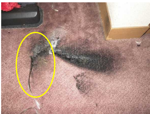
写真 15-3 焼損した鼻カニューレの状況
