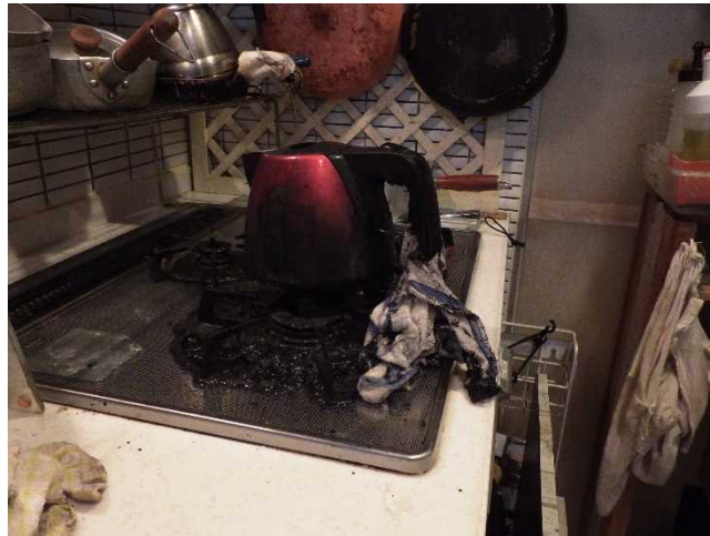
写真 15-2 焼損した電気ケトルの状況
