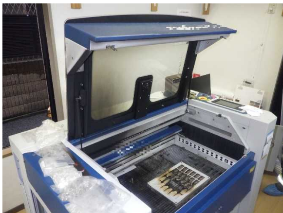
写真 24-1 レーザー加工機の焼損状況
