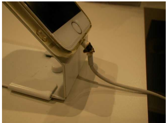
写真 20-4 充電ケーブルのコード部の焼損状況
