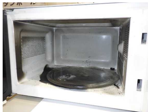
写真 20-2 電子レンジ内の焼損状況
