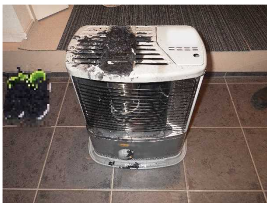
写真 8-1 石油ストーブの焼損状況
