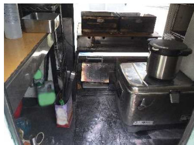
写真 10-2 車内の焼損状況
