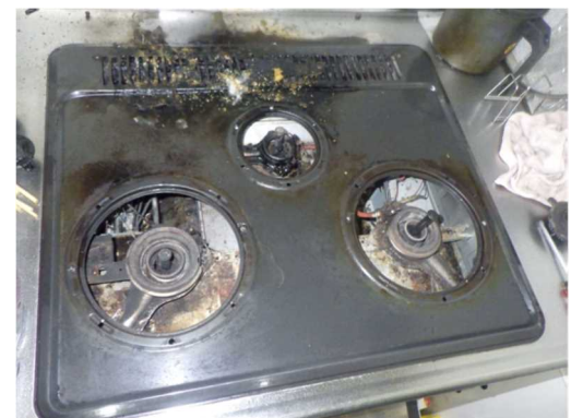
写真 7-7 ガステーブルの焼損状況
