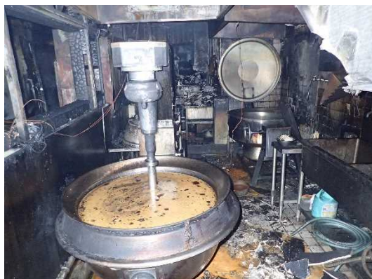
写真 9-1 食品加工所回転釜の焼損状況
