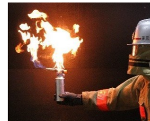
ガス漏れで消火不能に!
