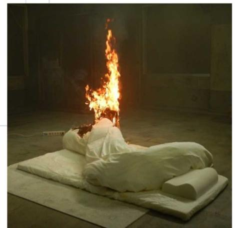
電気ストーブに布団が接触し出火した様子
