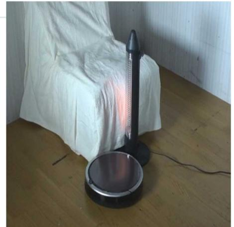
電気ストーブがロボット掃除機に押されてソファに接触した様子
