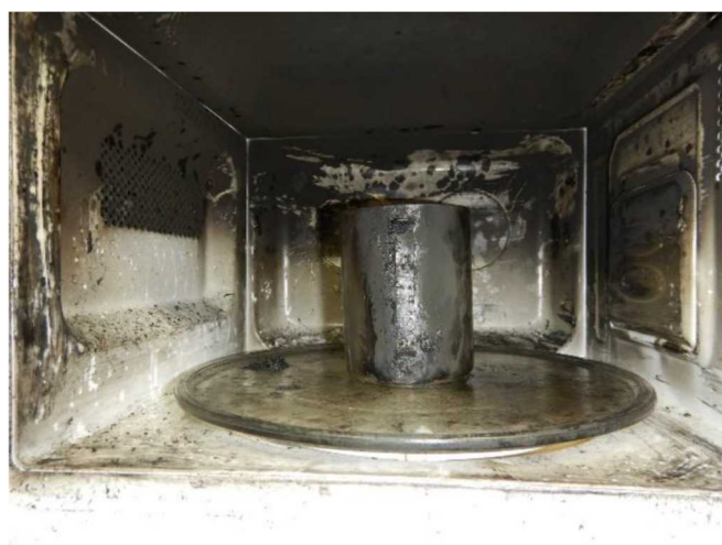
「金属製コップを加熱したため出火した火災」
