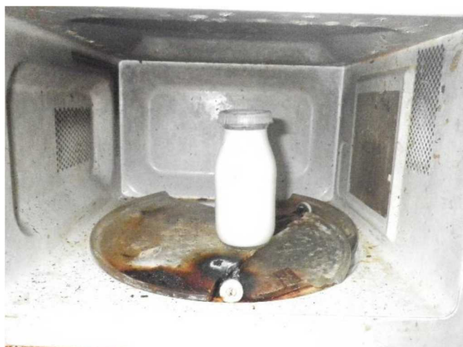
「庫内に付着した油かすが加熱されて出火した火災」
