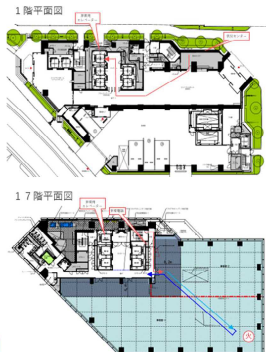
図 2-2-8 対応行動の一部をシステム等に代替した自衛消防活動の行動予測
