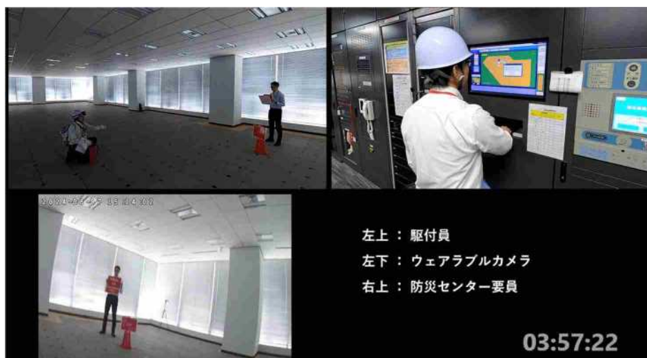
3分57秒 防災センター勤務員が総合操作盤で排煙機起動
