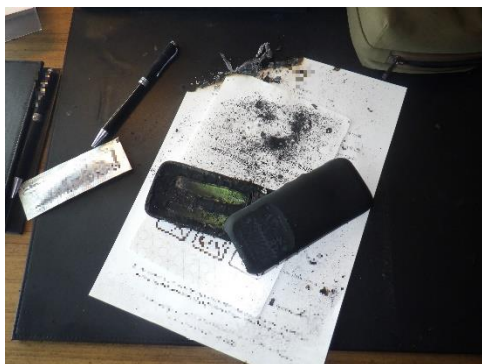
写真１ モバイルバッテリーの焼損状況
