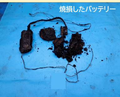
電動アシスト付自転車のバッテリーを純正品と出力が異なるACアダプタを使用して充電していたところ、バッテリーセルが短絡し出火しました
