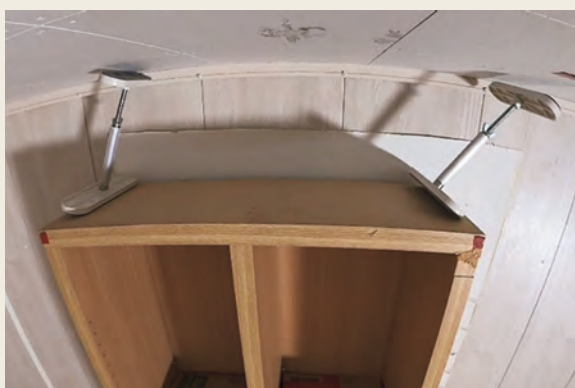
▲ 1年間の観測地震波を用いた家具転倒防止器具の転倒防止効果に関する研究
