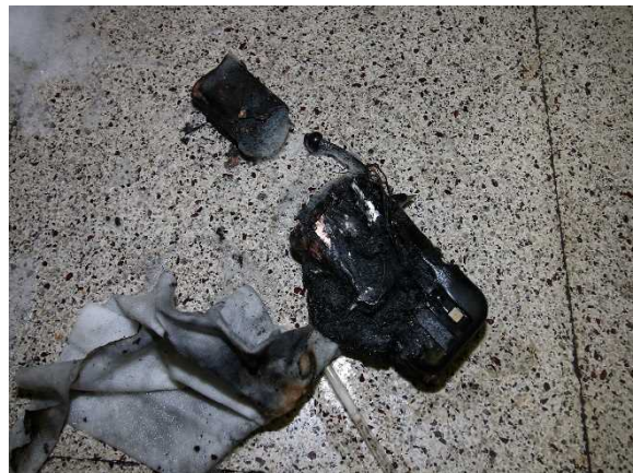
写真 6-2 モバイルバッテリーの焼損状況
