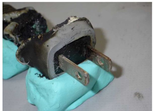
写真 21-4 差込みプラグの焼損状況
