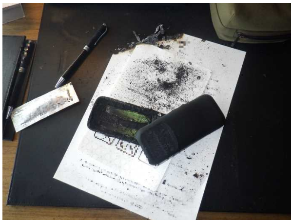
写真 21-1 モバイルバッテリーの焼損状況
