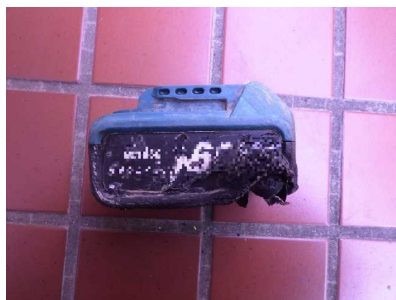
写真 6-5 バッテリーの焼損状況
