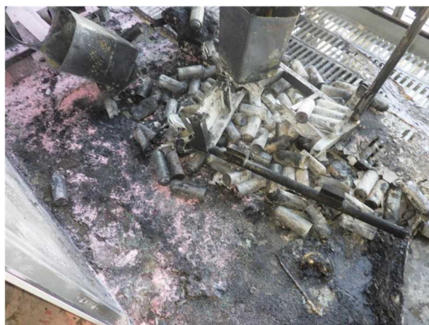
写真 11-2 スプレー缶塗料の焼損状況
