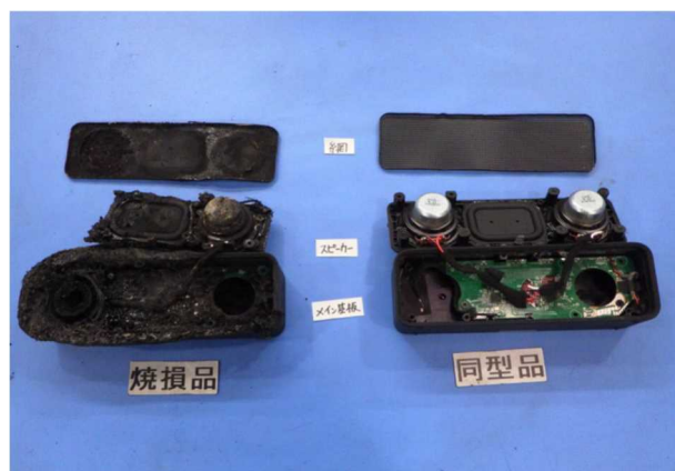
写真 23-2 ワイヤレススピーカーの焼損状況
