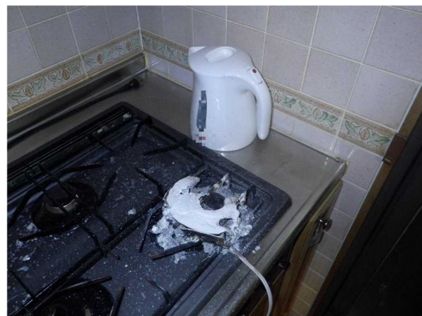
写真 15-2 電源プレートの焼損状況
