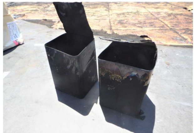
写真 28-4 一斗缶の焼損状況
