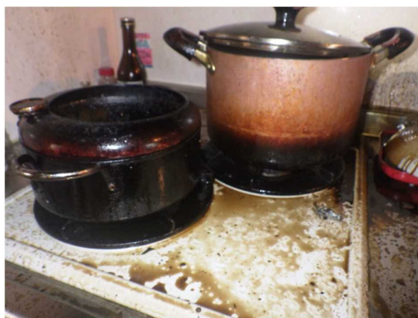
写真 18-10 出火した鍋(左手前)の焼損状況
