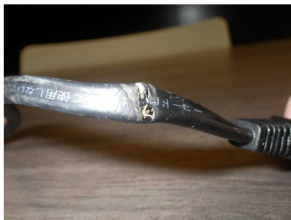
写真 26-5 焼損したコードの状況
