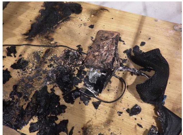
写真 30-4 モバイルバッテリーの焼損状況
