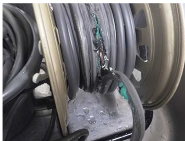
写真 26-2 コードリールの焼損状況
