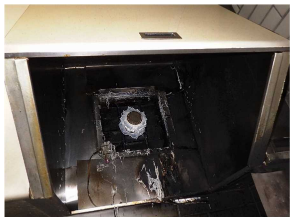
写真 18-4 レンジフードの焼損状況
