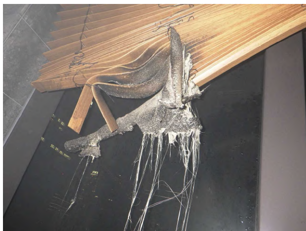
写真 5-1 電動ブラインドの焼損状況
