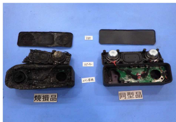
写真 23-2 ワイヤレススピーカーの焼損状況
