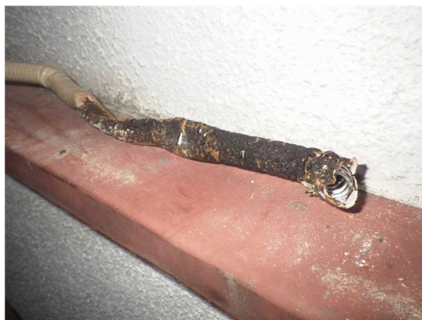
写真 16-2 焼損したガスホースの状況
