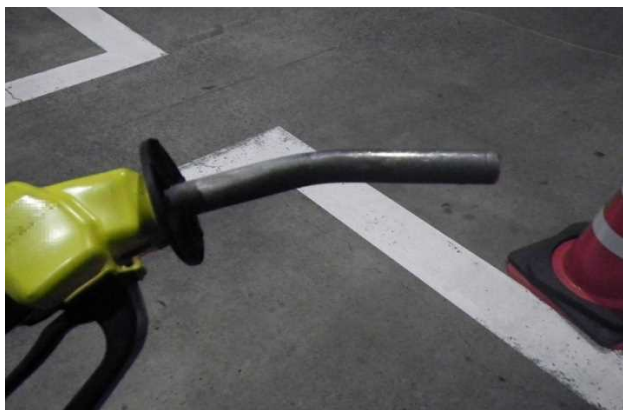
写真 28-1 焼損したノズルの状況
