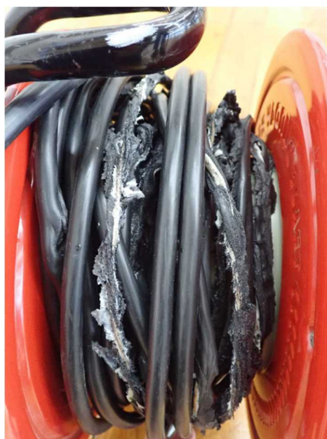
写真 23-4 コードリールの焼損状況
