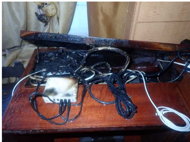
写真 30-1 焼損したモバイルバッテリーの状況
