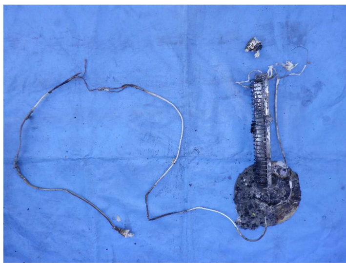
写真 18-2 焼損したカーボンヒータの状況
