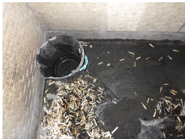
写真 2-2 焼損したバケツの状況
