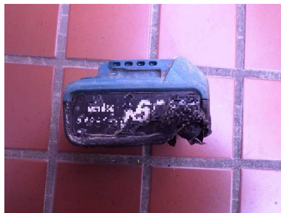
写真 6-5 バッテリーの焼損状況
