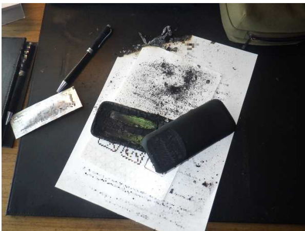
写真 21-1 モバイルバッテリーの焼損状況
