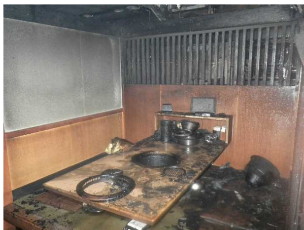
写真 19-4 無煙ガスロースタの焼損状況
