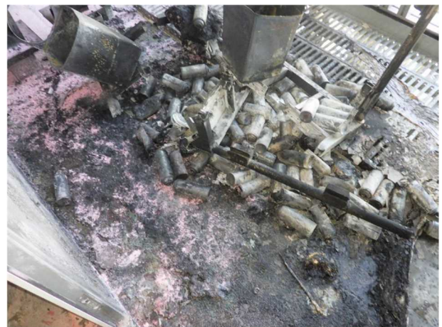
写真 11-2 スプレー缶塗料の焼損状況
