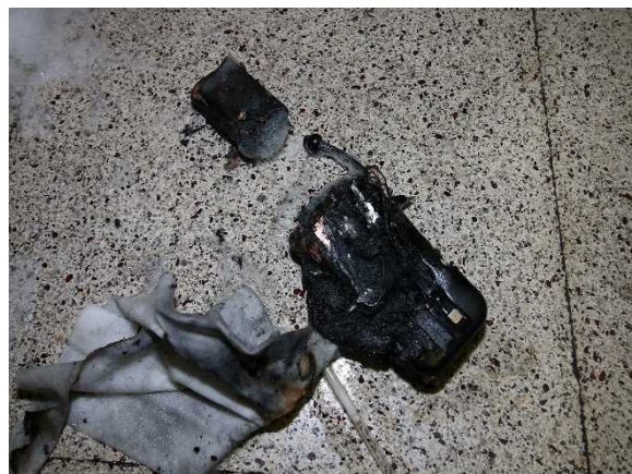
写真 6-2 モバイルバッテリーの焼損状況
