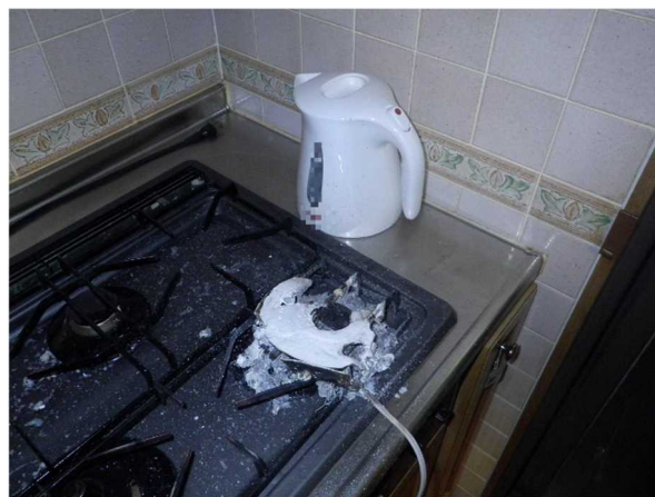
写真 15-2 電源プレートの焼損状況
