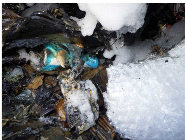
写真 11-4 焼損したスプレー缶の状況
