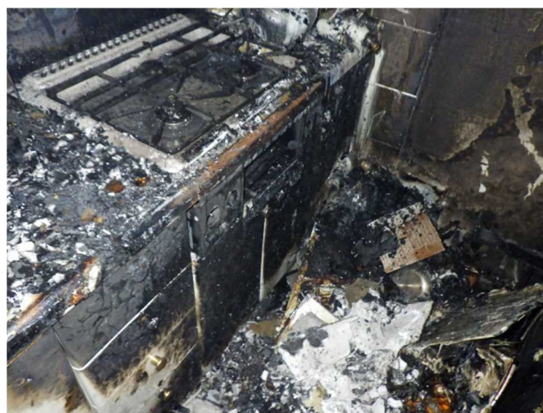
写真 7-4 ガステーブルの焼損状況
