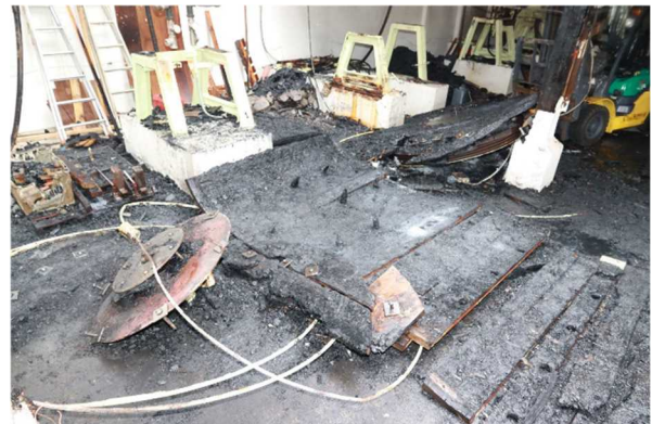
写真24-2 解体する装置の焼損状況
