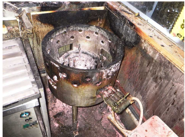
写真 27-2 大型ガスこんろの焼損状況
