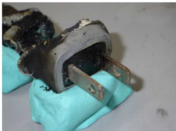
写真 21-4 差込みプラグの焼損状況
