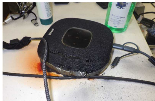
写真 13-2 焼損したスピーカーの状況
