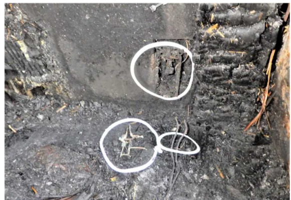
写真 14-2 壁付コンセントの焼損状況
