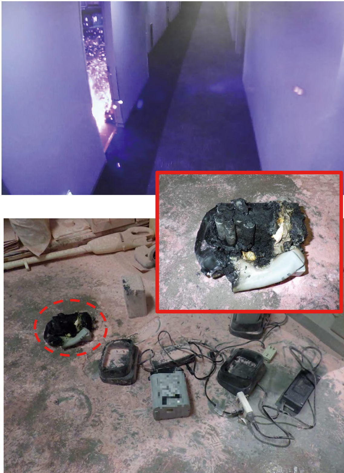
①充電中のコードレス掃除機のバッテリーから 出火した火災（10月）
