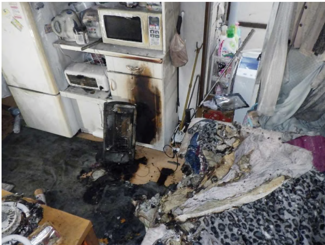
②電気ストーブにごみ袋が接触し出火した火災（1月）
