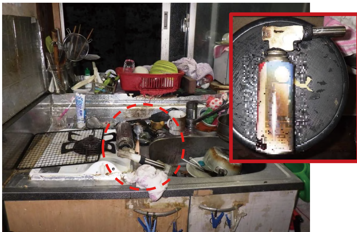
①ボタンガストーチバーナのガス導管から 漏気したガスに引火して出火した火災（7月）
