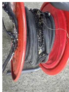
写真8 コード部分の焼損状況
