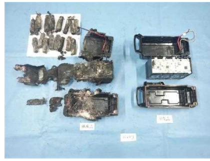
写真4 焼損したバッテリーの状況
