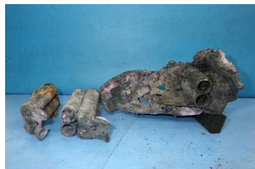
写真2 バッテリーの焼損状況
