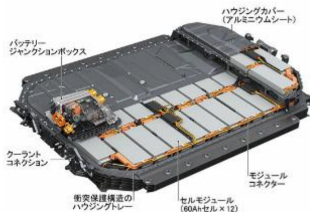
図 1-11 電気自動車のリチウムイオンバッテリーの搭載状況の一例（ラミネート型）
