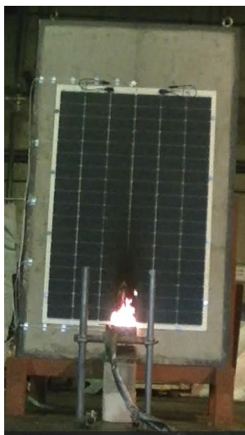
図 4-5 試験体 1（バーナ除去後の試験体の燃焼状況）
