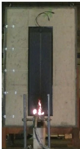
図 4-8 試験体 2（バーナ除去後の試験体の燃焼状況）
