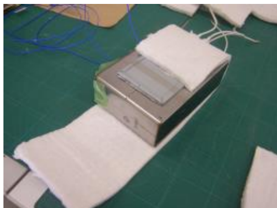
図 3.7 LFP 系セルの断熱
