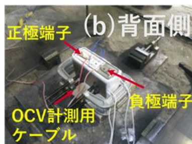
図 3.8 LFP 系セルの拘束と小ピット内への設置の概要 (a) 正面側, (b) 背面側
