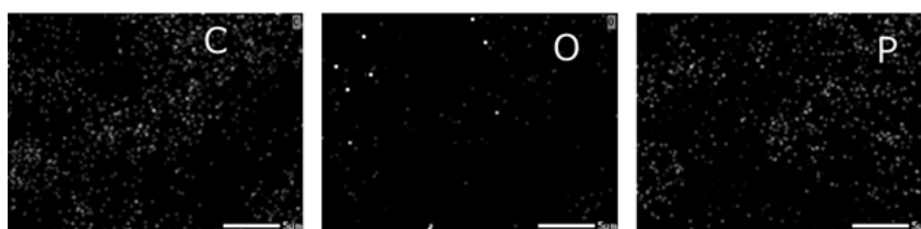
図 3.38 図 3.37 の SEM 像における原子マッピング
