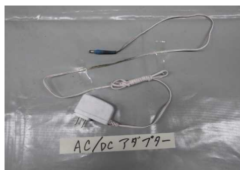
写真4 使用した他社製品の充電器 （出力電圧 36V）
