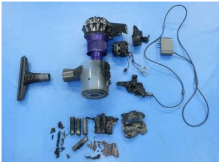
写真1 コードレス掃除機の 焼損状況
