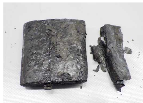
写真４ 焼損したモバイルバッテリー
