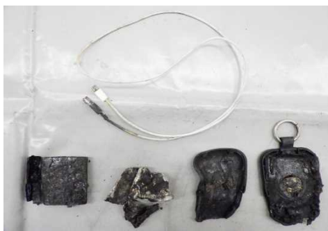
写真３ 焼損したモバイルバッテリー
