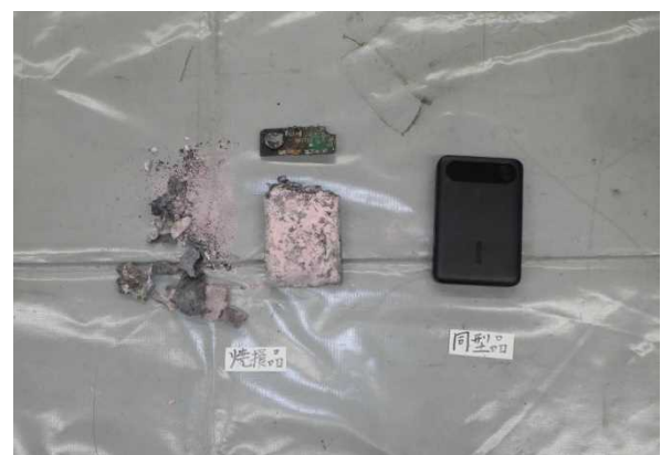
写真 13 モバイルバッテリーの焼損状況
