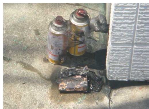
写真4 モバイルバッテリーの焼損状況
