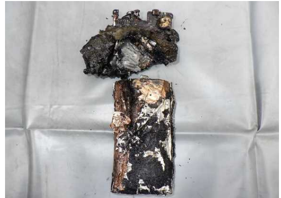
写真6 モバイルバッテリーの焼損状況
