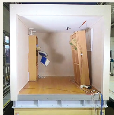
▲振動実験棟 周期的な揺れや、地震動を再現することができます。
