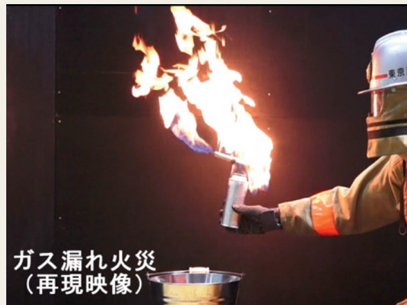
▲ ガストーチバーナーに起因した火災の再現実験
