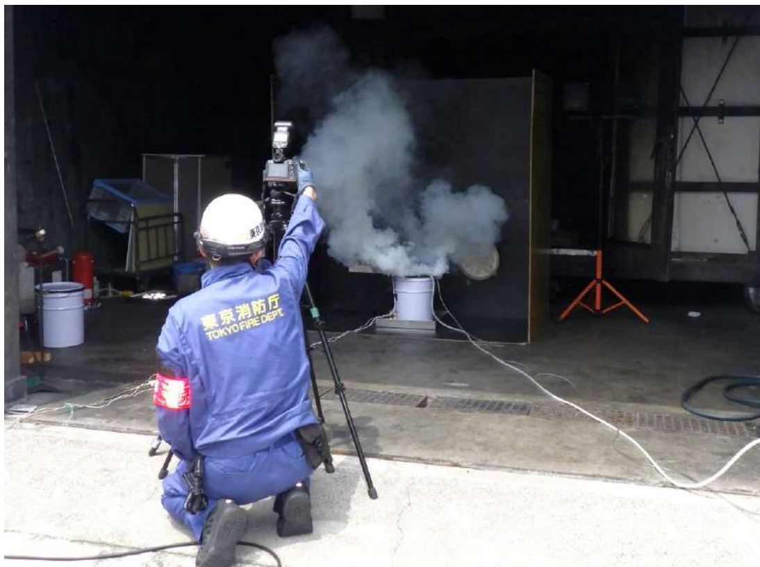
①リチウムイオンバッテリーの保管に関する検証
