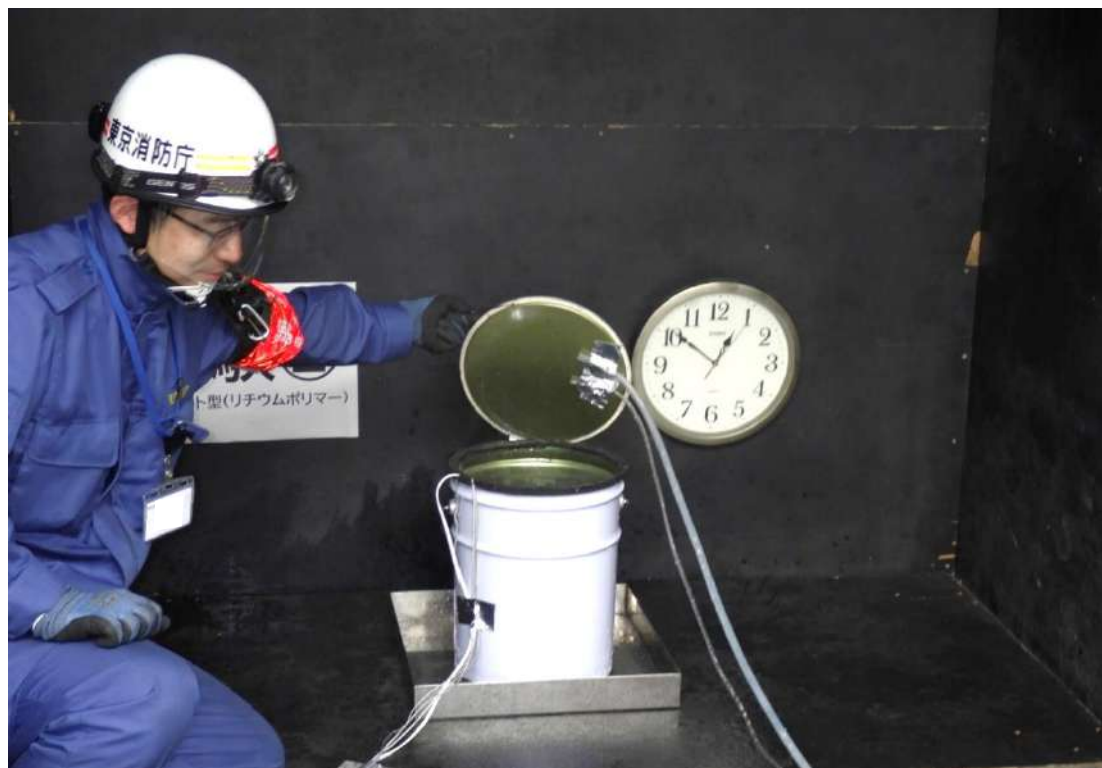
②リチウムイオンバッテリーの保管に関する検証
