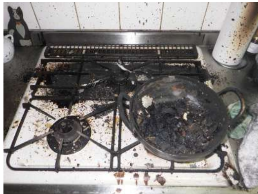
写真 9-2 鍋周辺の焼損状況
