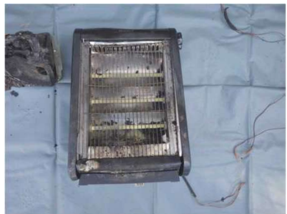
写真 6-2 電気ストーブの焼損状況
