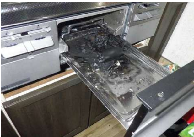
写真 18-6 グリルの焼損状況
