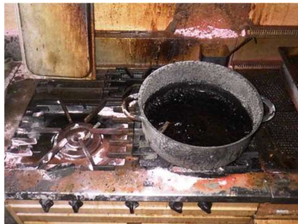
写真 7-2 火元の食用油周辺の状況
