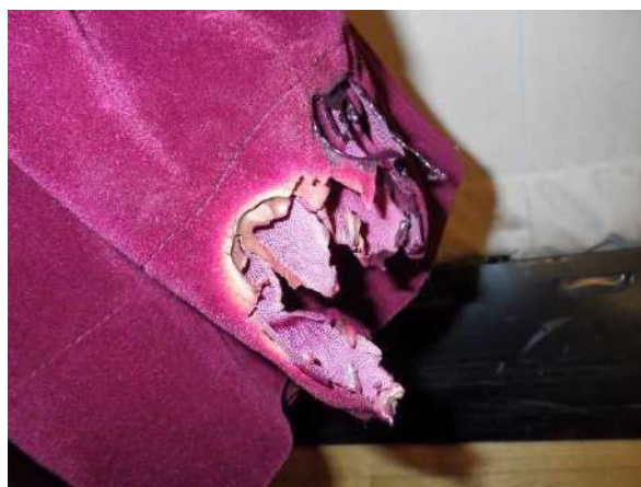
写真 31-2 カーテンの焼損状況
