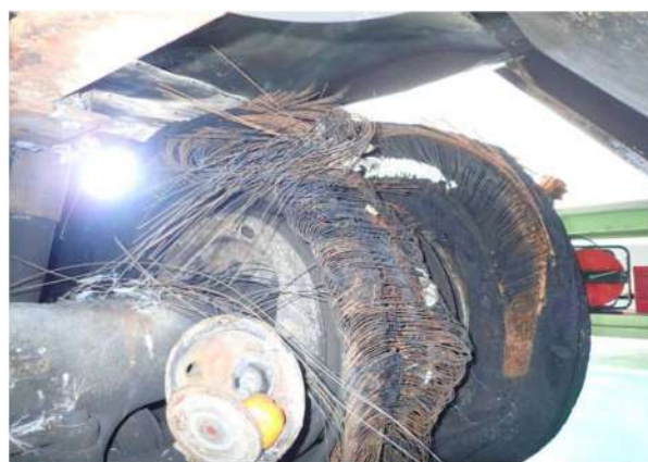
写真 29-2 出火したタイヤの状況
