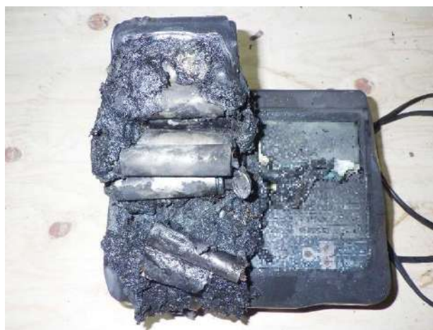
写真 16-2 焼損したバッテリーの状況
