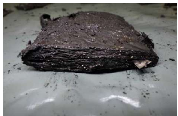
写真 21-5 バッテリー内部のセルの状況
