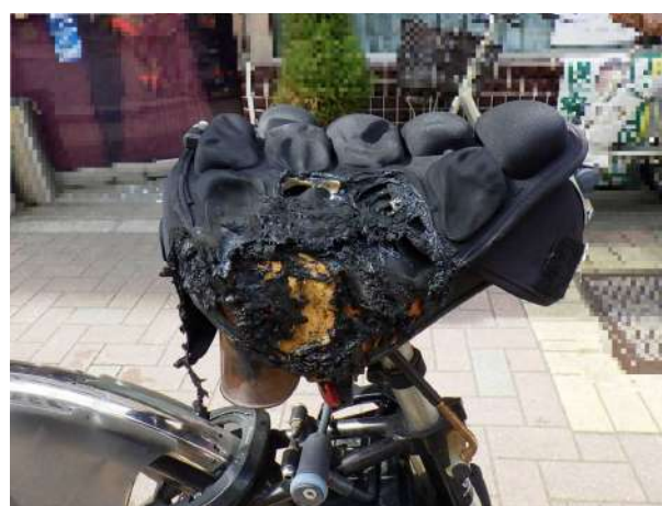
写真 4-4 自転車の焼損状況
