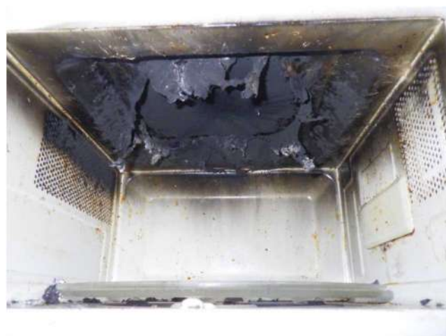
写真 6-6 焼損した電子レンジ庫内状況
