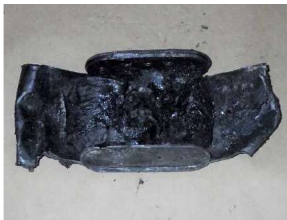
写真24-2 低圧進相コンデンサの焼損状況
