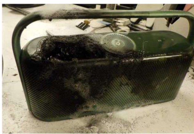
写真 6-8 焼損した充電式スピーカーの状況
