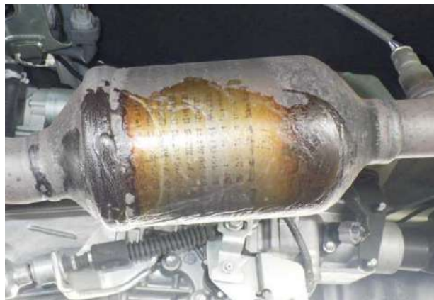
写真 29-4 排気管の焼損状況
