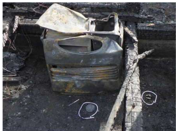
写真 11-2 破裂したスプレー缶の状況
