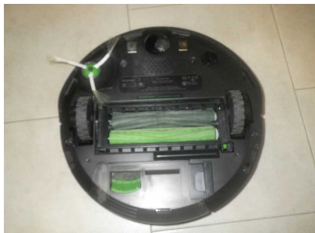
写真 6-4 出火要因のロボット掃除機の状況
