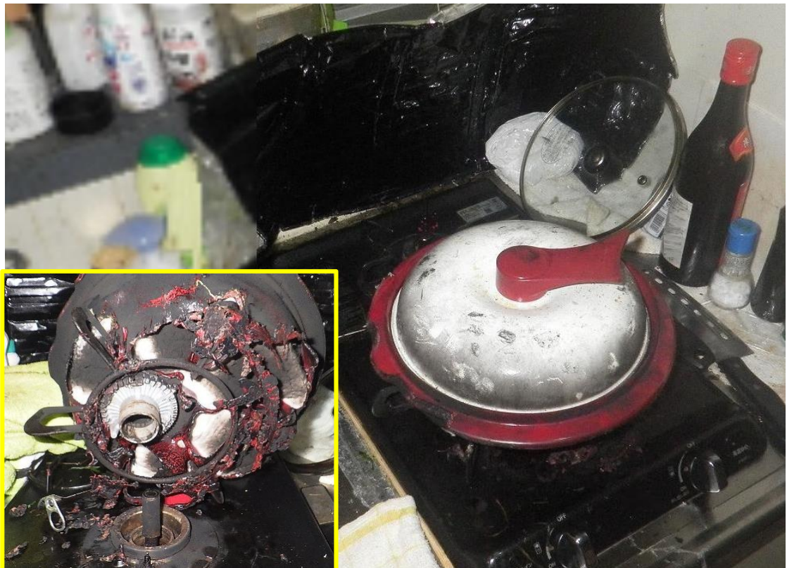
④電子レンジ専用調理器具の使用方法を間違えて 出火した火災（4月）
