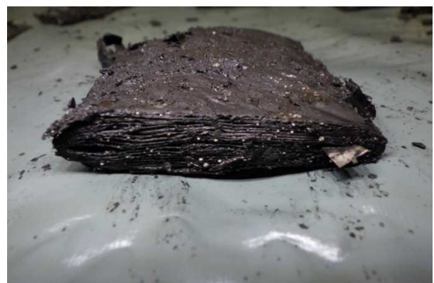
写真 21-5 バッテリー内部のセルの状況
