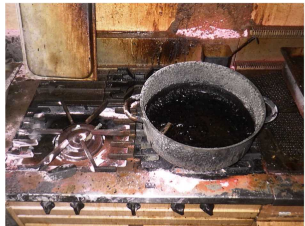
写真 7-2 火元の食用油周辺の状況
