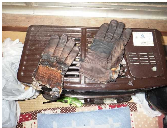
写真 8-2 手袋の焼損状況
