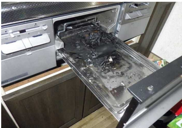
写真 18-6 グリルの焼損状況
