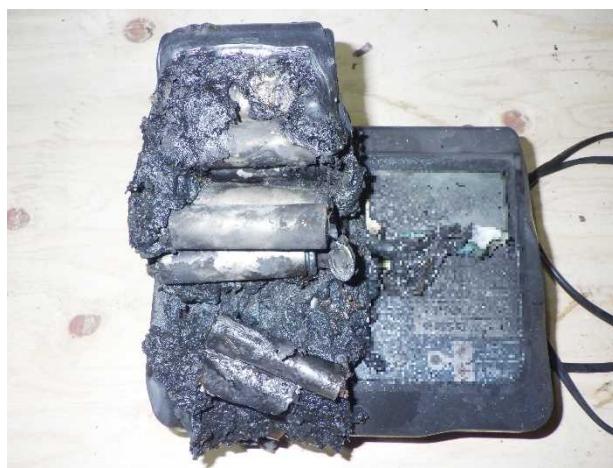
写真 16-2 焼損したバッテリーの状況
