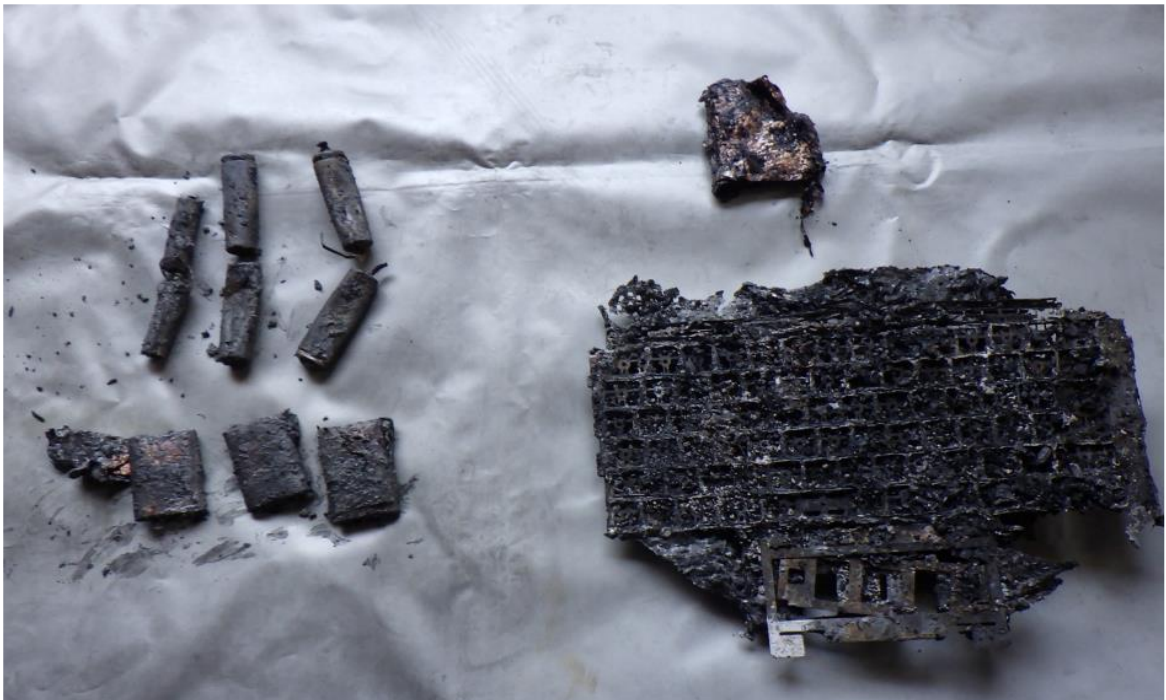
①リチウムイオン電池から出火した火災（11月）
