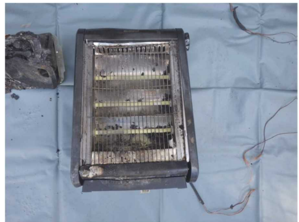
写真 6-2 電気ストーブの焼損状況
