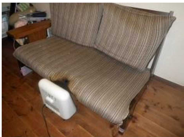
写真 6-3 電気ストーブとソファの接触状況
