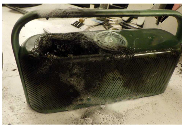
写真 6-8 焼損した充電式スピーカーの状況
