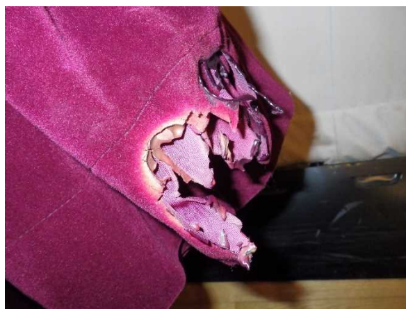
写真 31-2 カーテンの焼損状況
