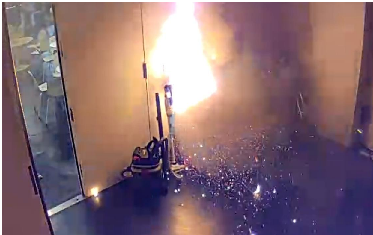
②充電中のコードレス掃除機のバッテリーから 出火した火災（11月）
