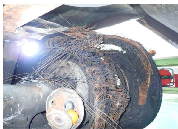
写真 29-2 出火したタイヤの状況
