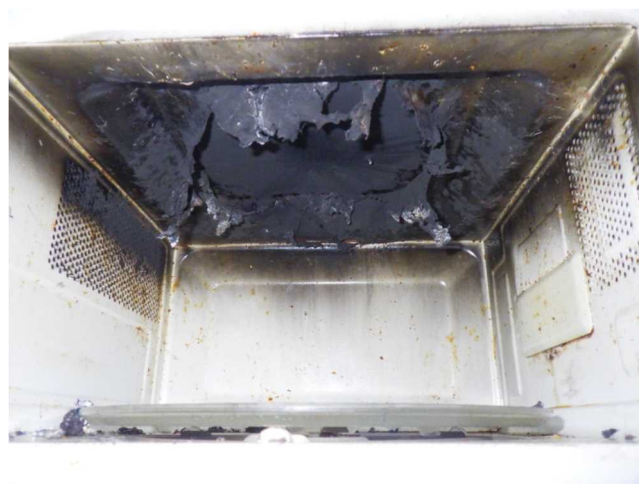
写真 6-6 焼損した電子レンジ庫内状況
