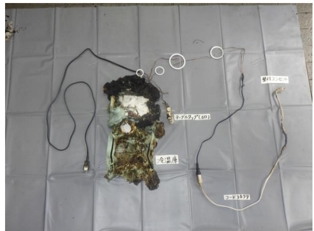
写真 14-2 電気冷蔵庫の状況
