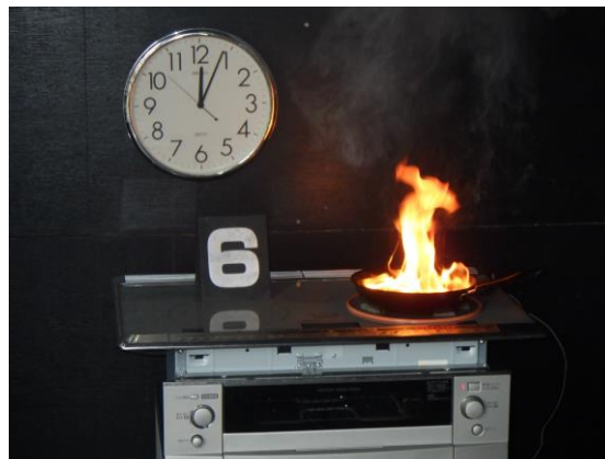
写真 6-2 再現実験の状況 （加熱開始、約4分で発火）
