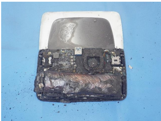
写真 6-5 モバイルパソコンの焼損状況
