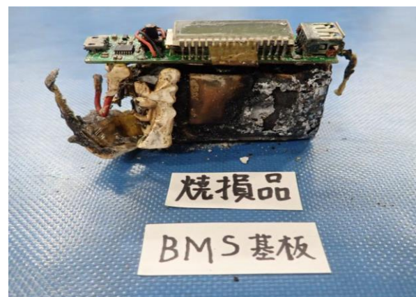
写真 6-4 モバイルバッテリーの焼損状況
