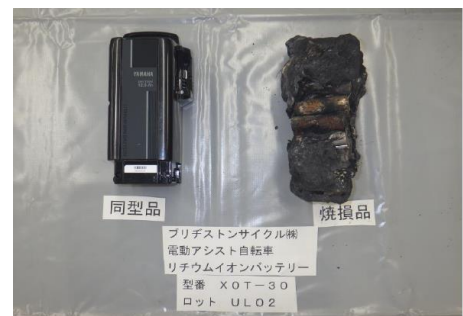
写真 13-2 焼損したバッテリーの状況
