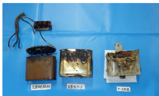
写真 24-3 コンデンサの焼損状況
