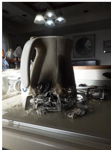
写真 15-2 焼損した電気ケトルの状況
