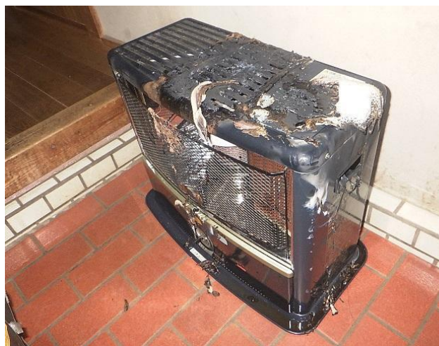
写真 8-3 焼損した石油ストーブの状況
