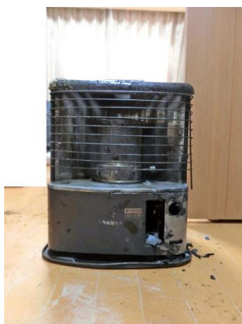
写真 8-1 石油ストーブの焼損状況
