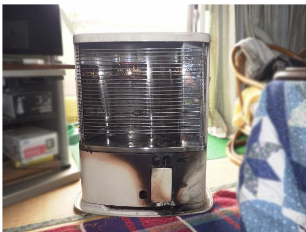
写真 8-1 石油ストーブの焼損状況
