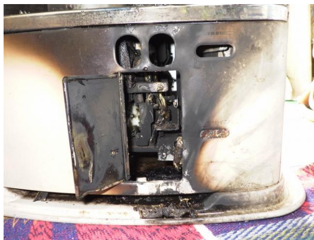
写真 8-2 操作扉内部の焼損状況
