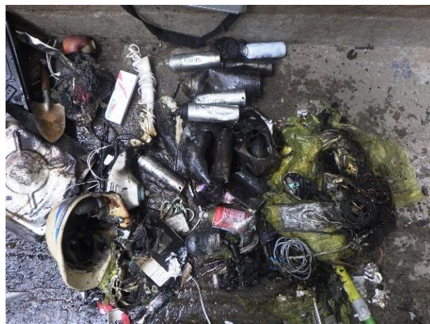
写真 11-5 焼損したスプレー缶の状況
