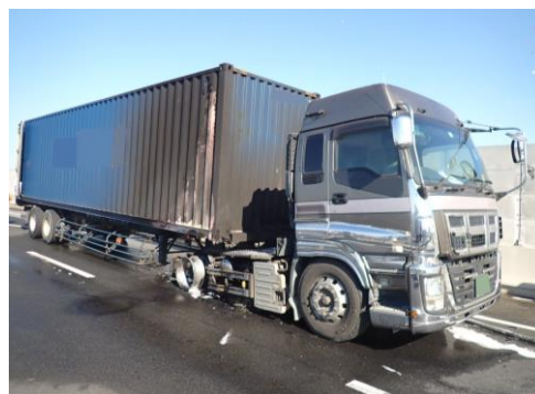
写真 29-1 車両の焼損状況
