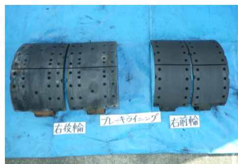
写真 29-3 ブレーキライニングの状況
