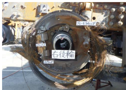
写真 29-2 右後輪の焼損状況
