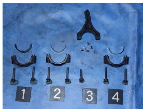
写真 30-2 コンロッドとメタルの破損状況
