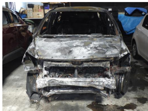
写真 30-1 車両の焼損状況
