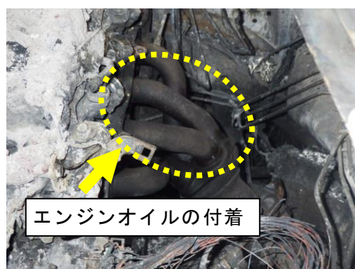
写真 30-3 排気管の状況
