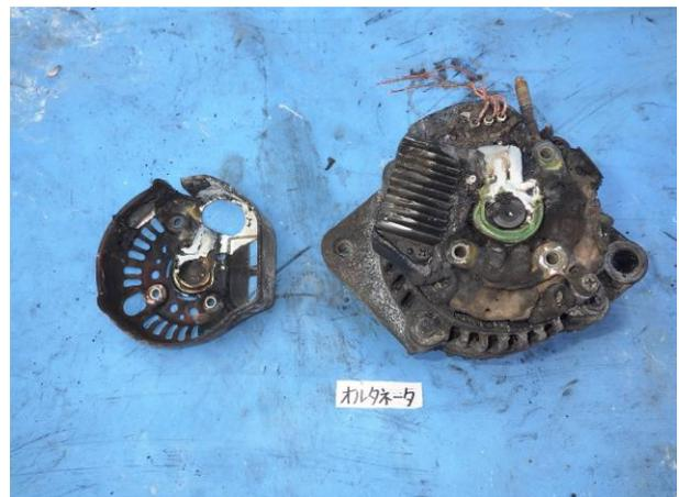
写真 6-13-2 オルタネータの焼損状況
